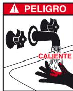
El agua que sale de la válvula de seguridad puede estar extremadamente caliente y provocar quemaduras muy graves.
